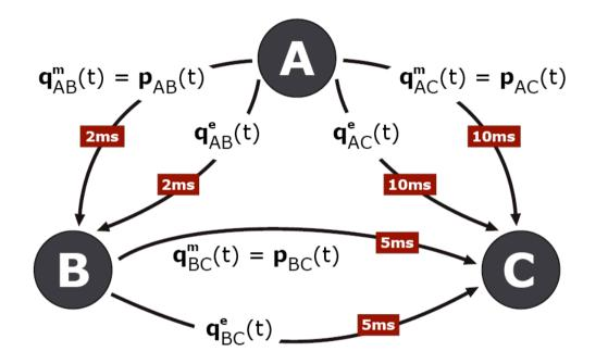
$\mathbf{P1}: A \xrightarrow{q^e_{AB}} B \xrightarrow{q^e_{BC}} C, \qquad \mathbf{P2}: A \xrightarrow{q^m_{AC}} C, \qquad \mathbf{P3}: A \xrightarrow{q^e_{AC}} C$
